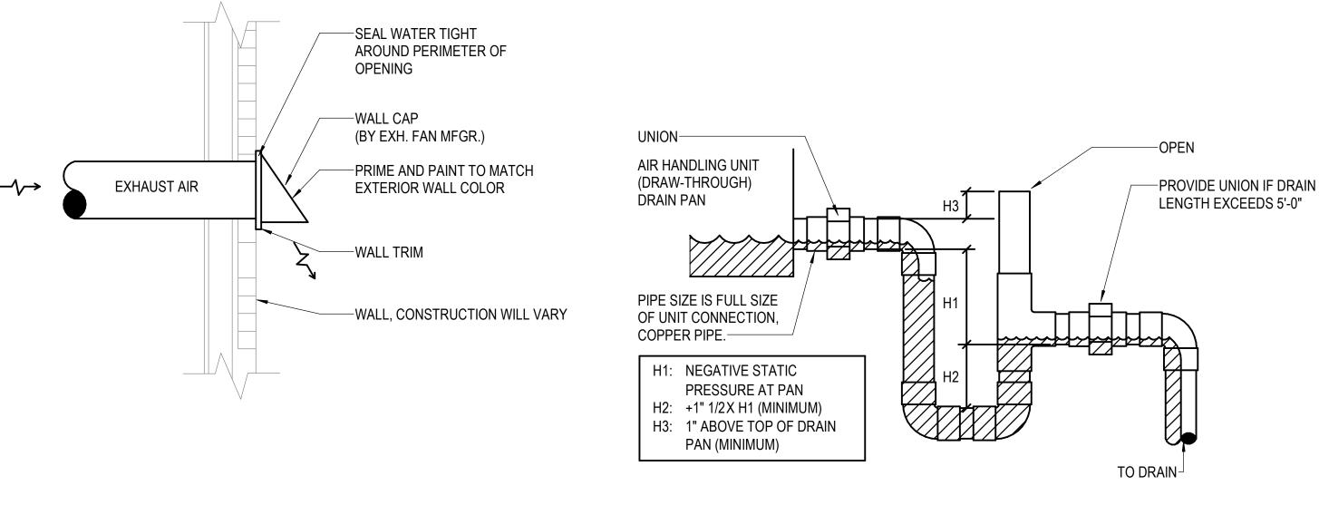
DRAW-THROUGH CONFIGURATION (AHU-1,2,3 & PAHU-1)
