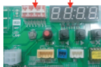
Circuit imprimé de l'unité extérieure
