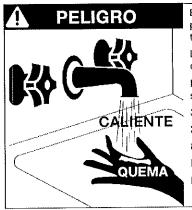
El agua caliente puede ser peligrosa, especialmente para los bebés, niños, personas de edad avanzada o enfermas. Si el termostato está fijo a una temperatura demasiado alta, existe el riesgo de escaldarse con agua caliente.
