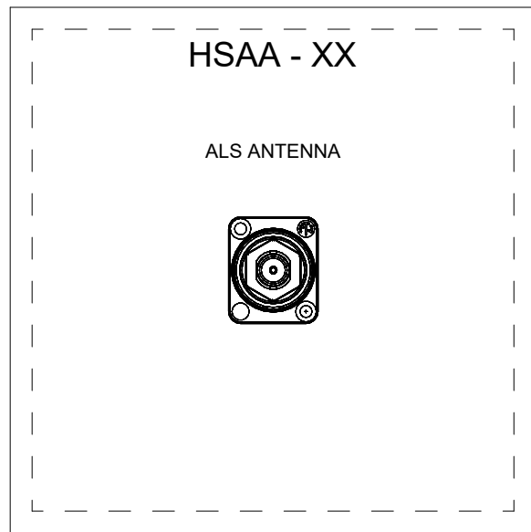
1 PANEL: HSAA - HOUSE ASSISTIVE LISTENING ANTENNA AV BOX TYPE: 6X6X6
