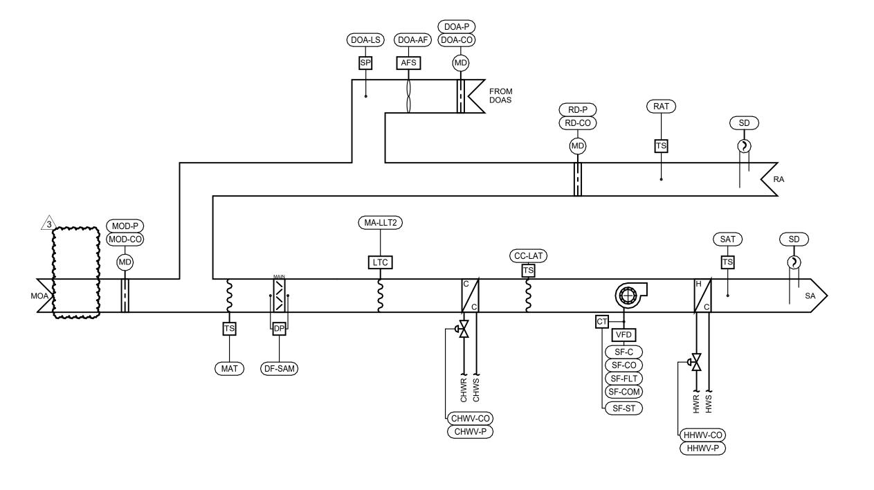
SINGLE ZONE VAV AHU **CONTROL SCHEMATIC** DUAL MAXIMUM CFM MODULATING HEATER
