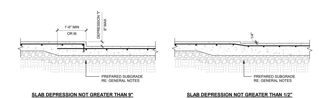
(C4) TYPICAL SLAB-ON-GRADE DEPRESSION DETAIL
