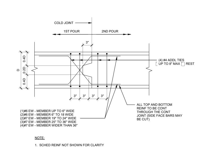
TYPICAL GRADE BEAM DETAIL AT CONSTRUCTION JOINT
